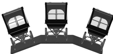
**Illustration 3. : Position perpendiculaire pour bloquer l'inclinaison**
