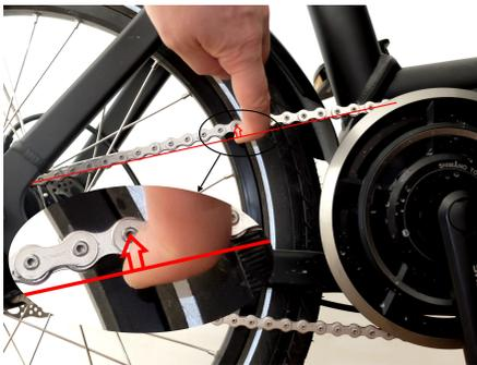
**Illustration 18. : Contrôle de la tension de la chaîne**
