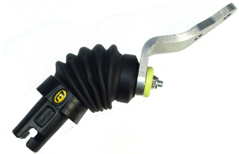
Figure 5 : Weberkupplung an Adapterplatte montiert
