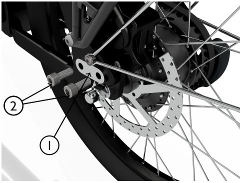
Figure 6 : Demontage der originalen Klemmplatte
