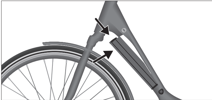
Abb. Tube Rahmenakku einsetzen
